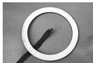
換気扇の器具コードに発生した二次痕
