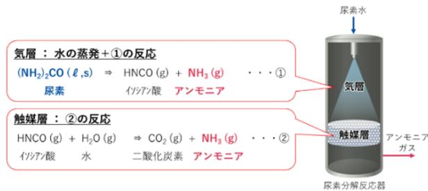
図2 尿素分解装置における尿素的加水分解反応
