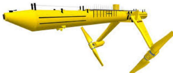
Fig. 9 Tidal power unit SR2000<sup>9)</sup> .
