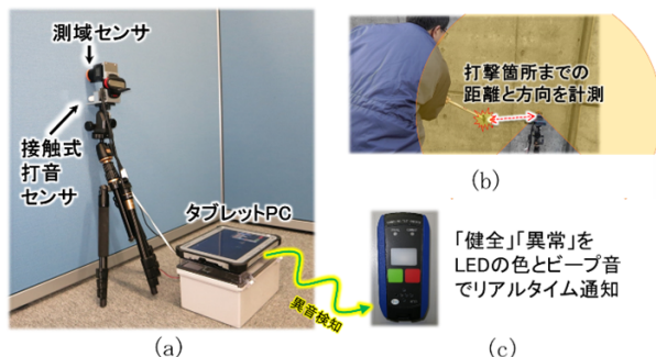
図2 (a)計測ユニットの外観 (b)測域センサーの計測範囲 (c)異音報知器
