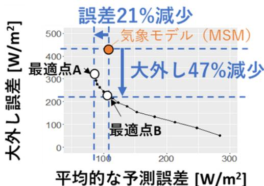
図11 機械学習モデルによる日射予測の大外し抑制と平均精度の最適化。13)の結果を表した図を改変。
