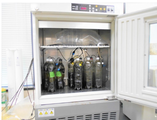
図 28 サツマイモの全熱量をメタンに変換する実験
