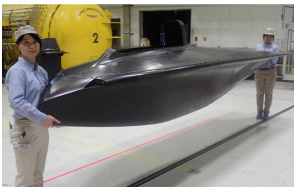
Fig. 17 Completed ultra-lightweight body. 図17 完成した超軽量車体。
