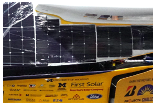
Fig. 7 Solar Module of Michigan Solar Team. 図 7 Michigan Solar Team の太陽電池モジュール。
