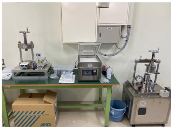
図2 粉末材料の成形・多孔体化に関する実験装置
